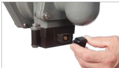
1. Retirez le couvercle antipoussière du capteur.
